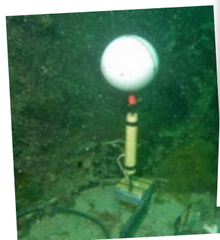
Sensorer från FOI för mätning av bland annat partikelrörelser i vatten.
